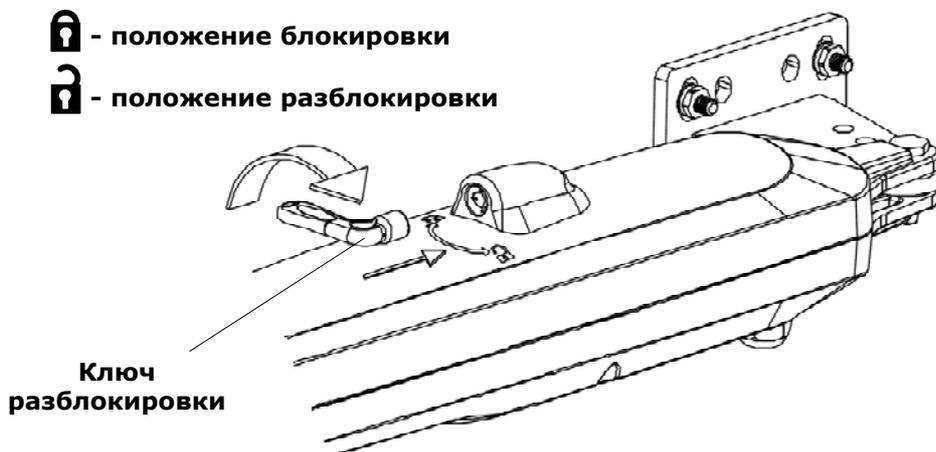
Рис. 7. Ручная разблокировка
