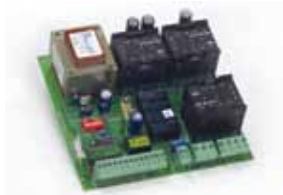
Плата управления 884 Т, встроенная Технические характеристики на странице 134
