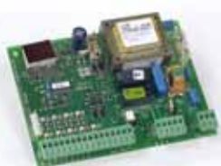
Плата управления 578 D (удаленная установка) Технические характеристики на странице 133
