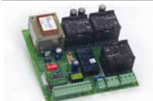
Плата управления 844 Т (*) (удаленная установка) Технические характеристики на странице 134
